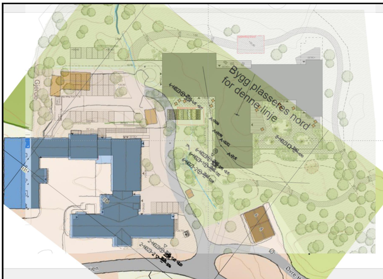
Figur 5 Skisse som viser plassering av bygg opp mot borpunkter og innmålt berg i dagen.
