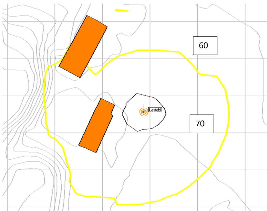
Fig 6.2.3a Direktestøy ved passering av lastebil
