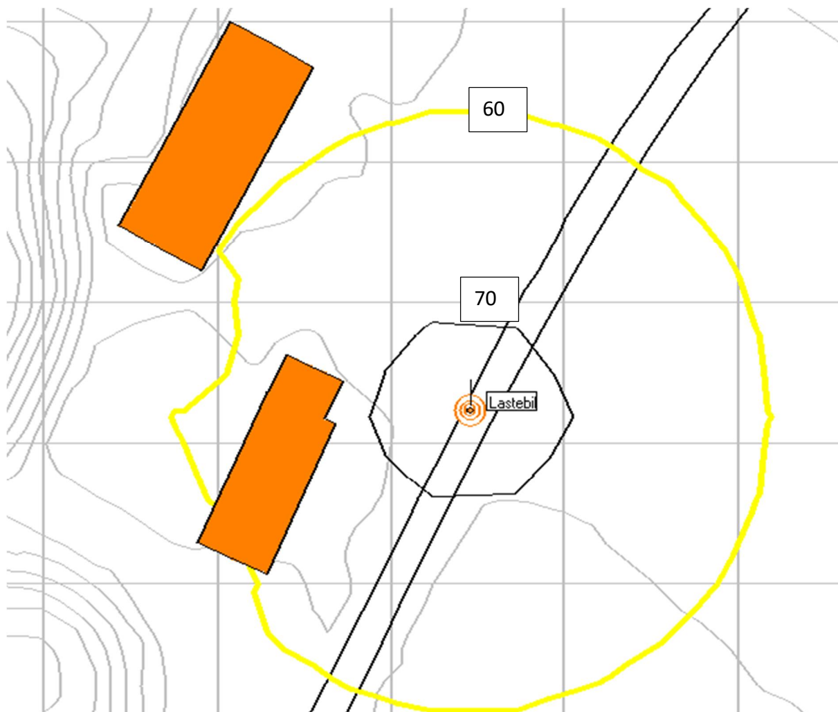
Fig 6.1.3a Direktestøy ved passering av lastebil
