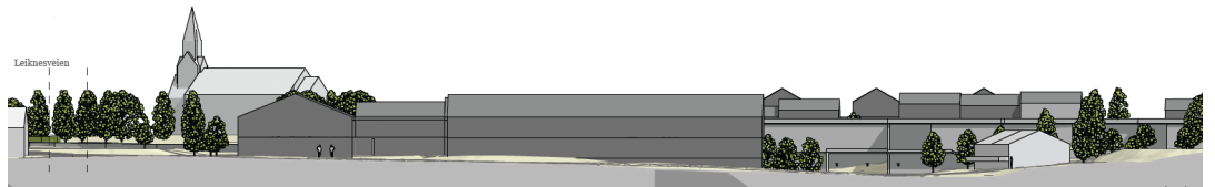
Langsnitt av Skeiveien, som viser ny foreslått bebyggelse innenfor B/F/K/T med mørk grå farge og nytt helsetun med mellomgrå og Leka kirke og eksisterende bebyggelse med lys grå farge.
